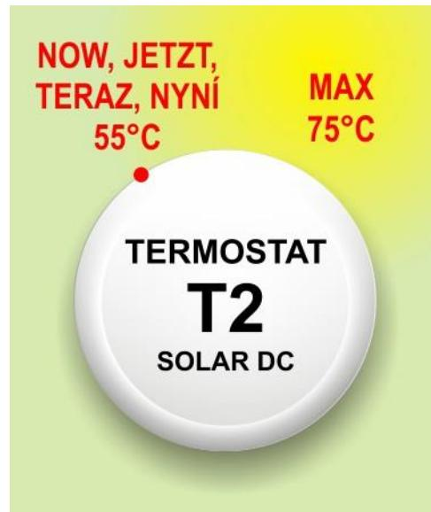
Termostat **T2** je umiestnený **pod krytom** elektroinštalácie a **nie je** voľne dostupný. Z výroby je nastavený na 55°C, pri montáži zásobníka vody sa môže teplota nastaviť **pootočením vpravo** na vyššiu teplotu. Max. teplota na termostate je 75°C.
